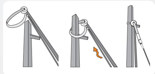
MISE EN PLACE DE L'ANCRAGE SUR POTEAU
