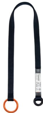
Le NELFF est une fausse fourche polyvalente très résistante. Fabriquée à partir d'une sangle d'amarrage en polyester, elle se caractérise par une très bonne résistance au frottement. D'une utilisation simple, la NELFF est équipée de 2 anneaux métalliques passant l'un dans l'autre, permettant ainsi d'installer et de récupérer la sangle depuis le sol.
