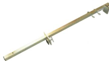
Le NBA60 est une barre d'ancrage transportable qui permet de créer un ou deux points d'ancrage dans les encadrements de portes ou fenêtres. Entièrement fabriqué en acier zingué, c'est un système d'ancrage résistant et fiable. Muni d'une platine mobile réglable, le NBA60 s'adapte dans des ouvertures dont la largeur est comprise entre 0,35 m et 1,24 m.
