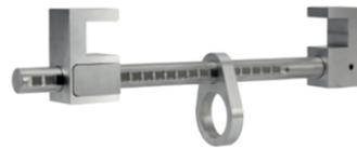
Point d'ancrage transportable pour IPN de 95 à 400 mm. Léger avec un poids de seulement 1,3 kg, il permet par simple pression latérale de régler la barre d'ancrage soit sur la partie supérieure, soit sur la partie inférieure de la poutre.
